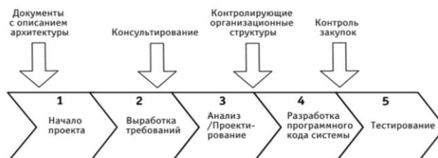
Рисунок 3 – Элементы управления и контроля архитектуры на различных этапах ИТ-проектов
