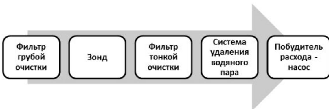
2. Охарактеризуйте вид, общую схему и особенности представленной последовательности отбора проб газа в ходе производственного экологического контроля:
