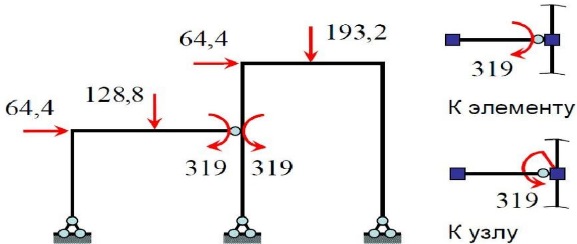
Загружение № 1 – силы с точностью до параметра  $F$
