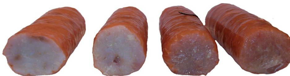
Рис. 5 - Образцы рыбного фарша после обработки давлением (слева направо): 400, 300, 200 и 100 МПа
