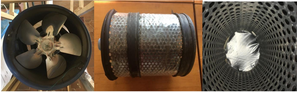
Рисунок 1– Рабочий орган исследуемого сепаратора: а) осевой вентилятор «Vком 315»; б) цилиндрический барабан; в) перфорированная сепарирующая поверхность;
