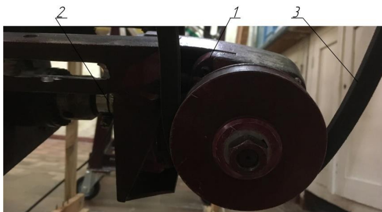
Рисунок 3 – Общий вид привода барабана сепаратора семян тыквы: 1 – редуктор; 2 – вал электродвигателя; 3 – ременная передача
