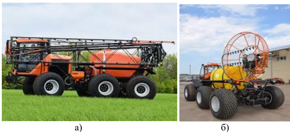
Рис. 3. Комплекс «Туман» для защиты растений: а)-штанговый опрыскиватель (в транспортном положении); б)-вентиляторный опрыскиватель
